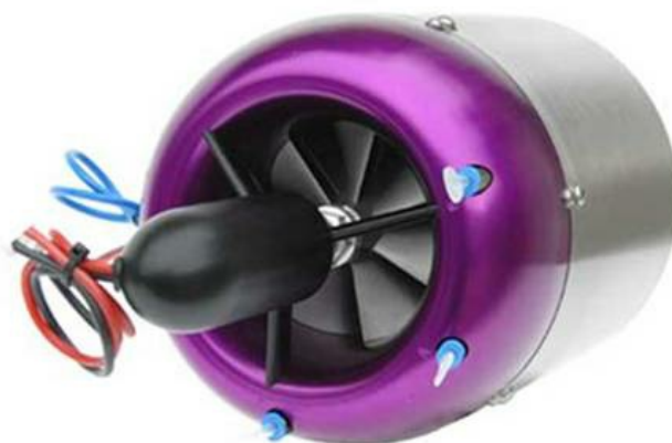
Le réacteur d'AMT, baptisé Titan, est une turbine alimentée par du kérosène (le Jet A1 des avions ou le fuel)
