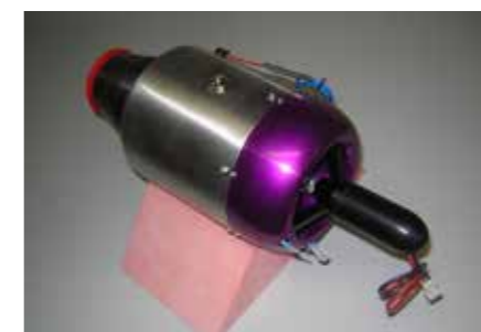
L'ibrido più originale al mondo: motore jet per decollo e volo, e motore elettrico sul carrello per accelerare a terra
