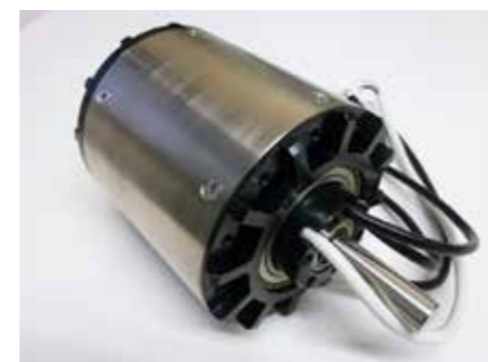
Il motore elettrico del Project GloW è utilizzato da tempo su scooter e quadricicli
